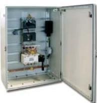
Ces coffrets permettent de commuter manuellement ou automatiquement l'alimentation des aéroréfrigérants sur une deuxième source. Ils assurent en outre la protection de la première, à proximité de laquelle ils sont installés (l'autre étant supposée protéger par ailleurs), et contiennent donc un inverseur et un disjoncteur.
