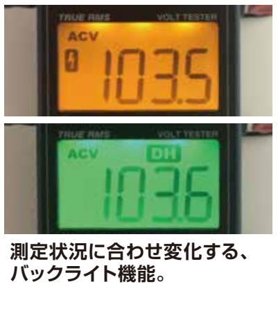
SELFモードで始業点検後、操作なしでそのまま電圧測定可能 漏電ブレーカーを落とす等の事故を防止。
