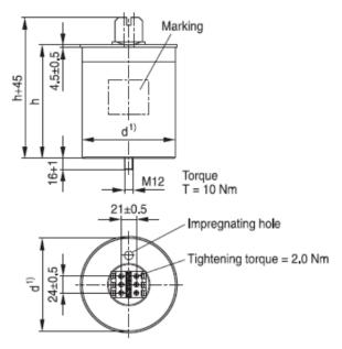
Creepage distance 12.7 mm min. Clearance 9.6 mm min.
