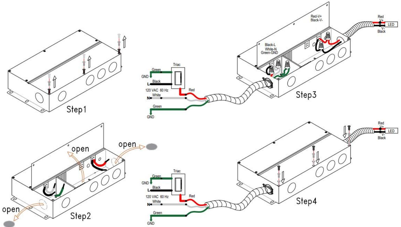
**Using Triac ELV wiring diagram**
