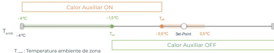
**Bloqueo de fuentes de calor.** Habilita o deshabilita el bloqueo de la fuentes de calor según las temperaturas exteriores de bloqueo definidas.
