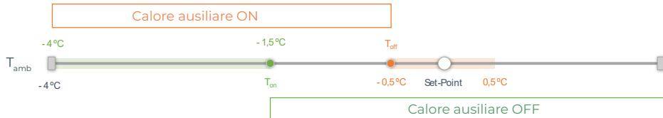
**Blocco delle fonti di calore.** Attiva o disattiva il blocco delle fonti di calore in base alle temperature esterne di blocco definite.
