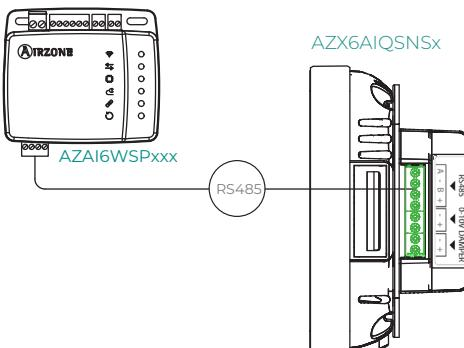
Gerät zur Steuerung und Überwachung der Innenraumluftqualität in einer Zone.
