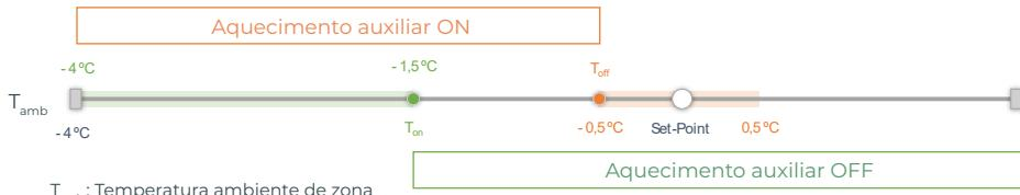
**Bloqueio de fontes de calor.** Ativa ou desativa o bloqueio de fontes de calor de acordo com as temperaturas externas de bloqueio predefinidas.
