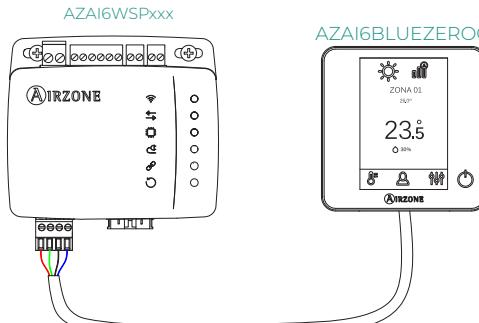
Dispositivo para el control de zona en un sistema Airzone.
