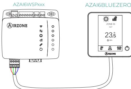
Dispositif de contrôle de zone dans un système Airzone.
