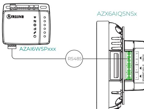
Dispositivo para el control y monitorización de la calidad del aire interior de una zona.
