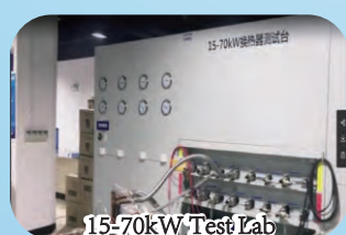
15-70kW换热器测试台
