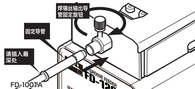
5-4. 将焊丝从后面的插入口进行导入，直到碰到驱动齿轮为止。焊锡丝的插入状态可通过保护盖的确认口来进行确认。
