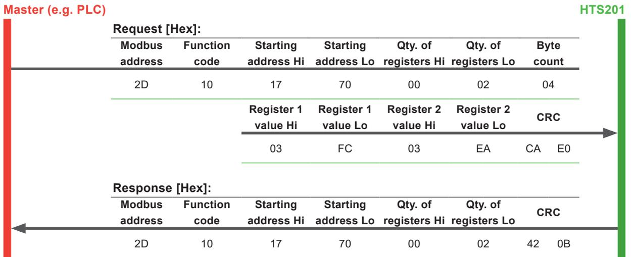
Fig. 5 Mapping a simple custom Modbus map
