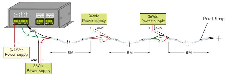
5.2 DMX wiring diagram.
