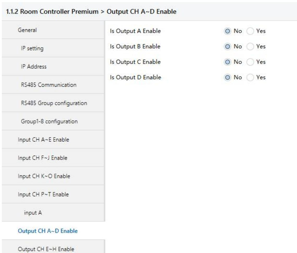
Fig. 5.13 parameter window “Output CH A~L enable”
