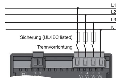
Anschlussvariante 3p 4w Spannungsmessung (Adr. 509 = 0, Standardeinstellung)
