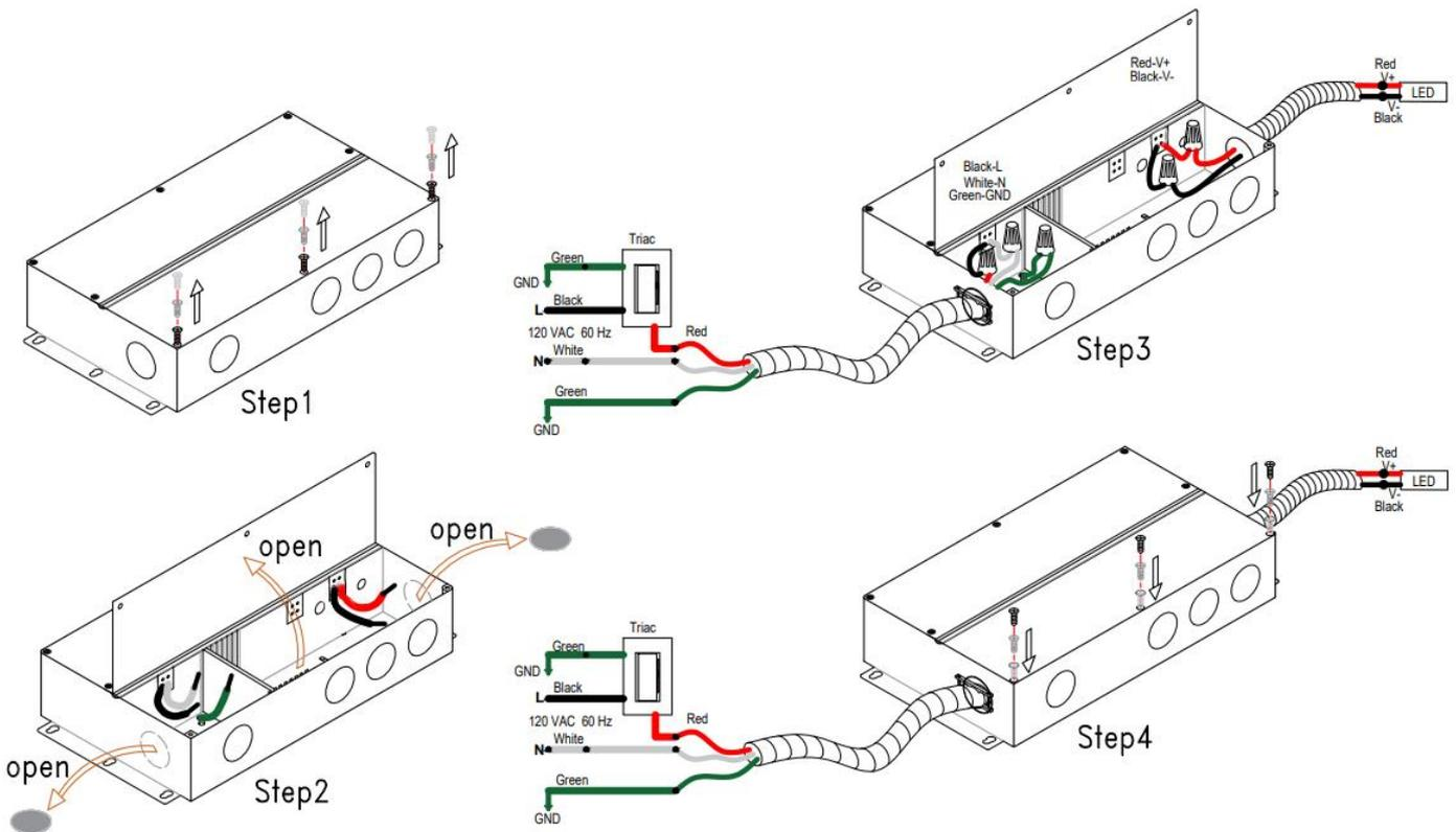
**Using Triac ELV wiring diagram**
