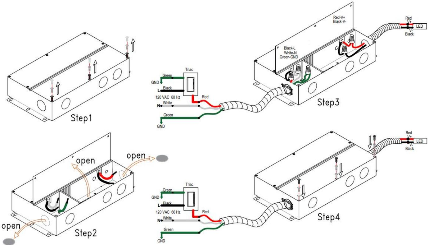
**Using Triac ELV wiring diagram**
