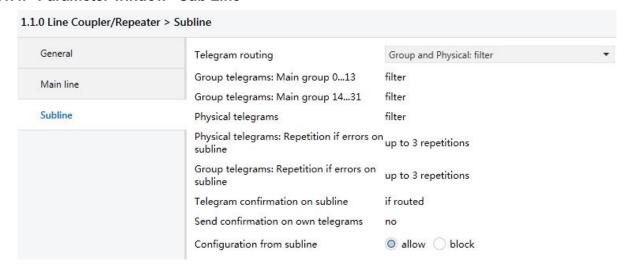
Fig.4.3: parameter window "Sub line"
