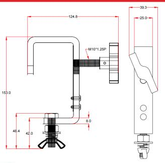
料号:CJS5038 载重:50KG 材质:铁 适用管径:35-51mm 单重:0.46kg 表面颜色:蓝锌/黑锌
