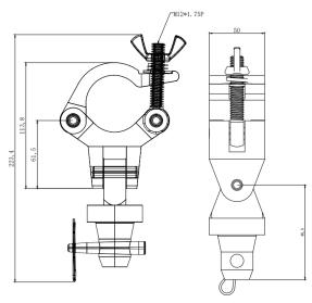
料号:CJS5024T 载重:200KG 材质:6061 适用管径:48-51mm 单重:0.71kg 表面颜色:阳极亮银/烤砂纹漆黑色
