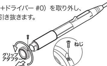
2. グリップラバーをひき抜き、代わりにチューブ Assy を下図のように挿入します。挿入後 1.と逆の手順でグリップアダプタを装着してください。
